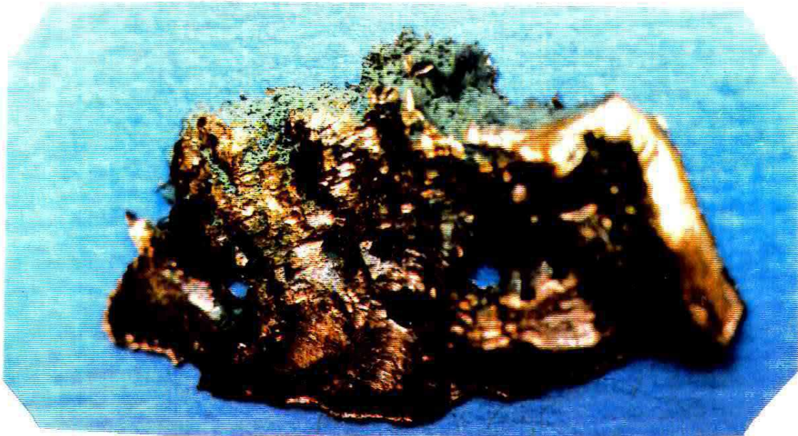
FIGURA 3. Fotografía de detalle de las muestras del metal constitutivo de la campana. Nótese la porosidad causada por el exceso de plomo.
